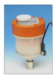
In den ALS Zylinder wird ein Magnetring eingepasst. Der Magnetsensor fragt die Lage des Auspresskolbens ab und gibt die Zustandsmeldung "leer" vom elektronischen Schmierstoffgeber an einen Signalgeber (z.B. Signallampe, Lautsprecher) oder die Steuerung ab. Bei der Meldung "leer" sind noch circa 5% Fettoder Ölreserve im Schmierstoffgeber vorhanden.
